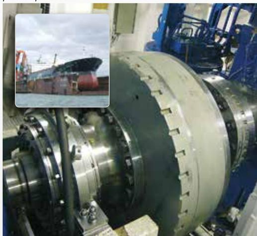
*Des moteurs, les boîtes de vitesse et les arbres porte-hélices de bateaux sont alignés avec le système Easy-Laser®. Grâce aux supports adaptables vous pouvez placer l'équipement à l'endroit le plus approprié ; axe, accouplement ou volant.*
